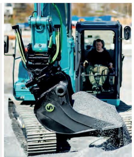
3 Zusatzleitungen als Serienausrüstung sorgen für einfaches Arbeiten mit Tiltrotatoren
