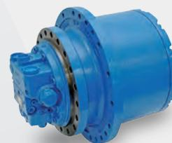
Jedes Kettenfahrwerk wird von einem Zweigang-Automatik-Fahrmotor angetrieben, der mit einer Bremse mit mehreren Bremscheiben, Federschloss und Hydraulikklüftung ausgestattet ist. Die einzigartige Fahrgeschwindigkeit liegt bei bis zu 5,3 km/h.
